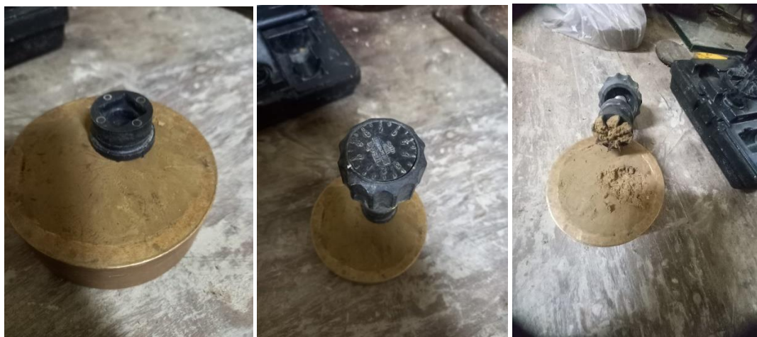
Figura 38. Ensayo Torvane realizado a la muestra extraída de la C2.
