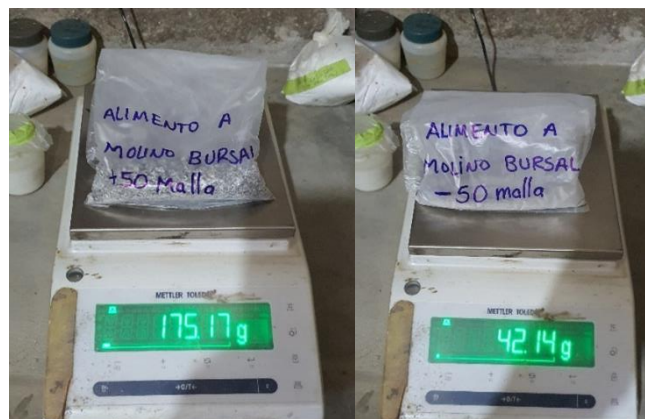
Figura 4.9 Proceso ensayo granulométrico. [Autor]
