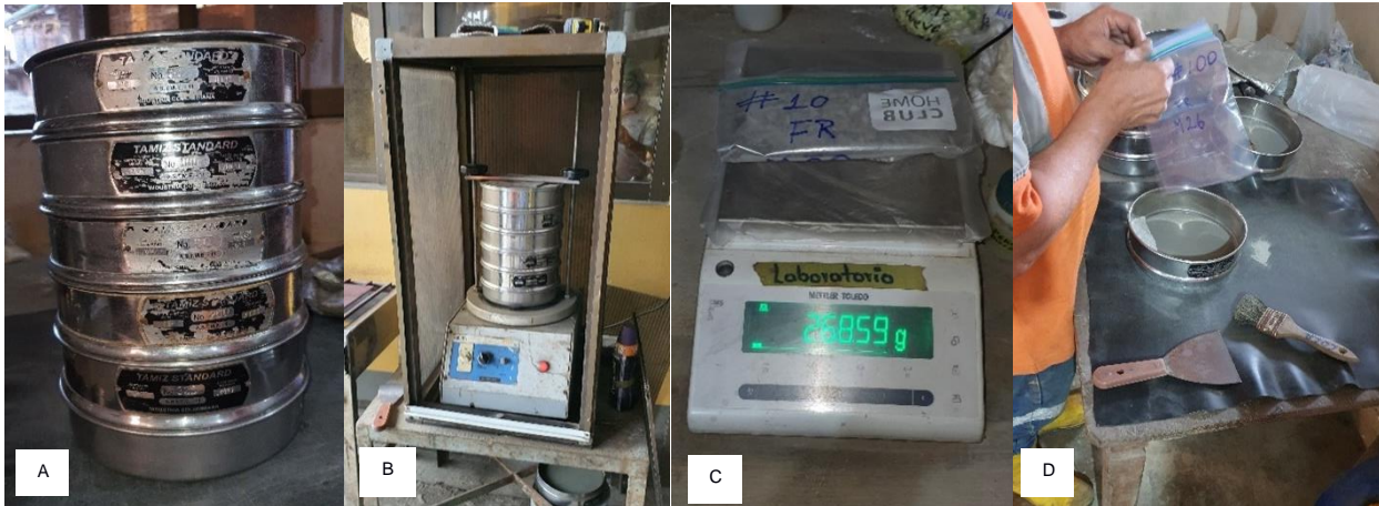
Figura 4.5 Implementos y equipos para ensayos granulométricos. [Autor]
