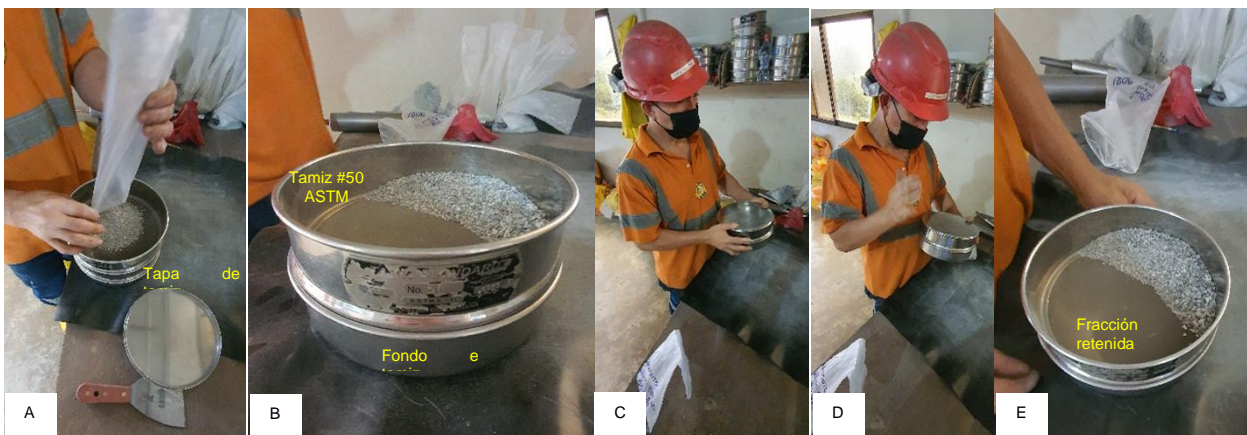
Figura 4.8 Proceso ensayo granulométrico. [Autor]
