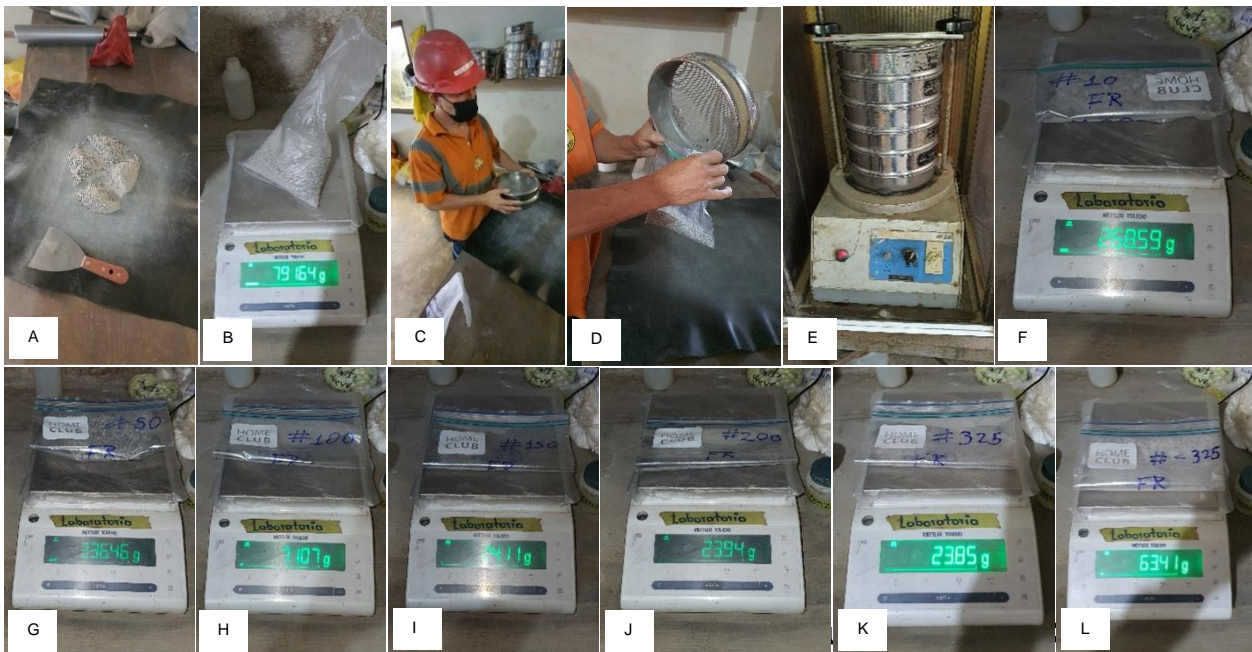
Figura 4.6 Proceso de tamizaje de muestra M-001. [Autor]
