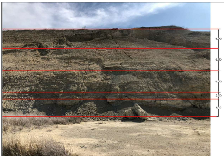
Figura 44. Identificación de estratos en talud del km1.9 de la vía San Mateo - Santa Marianita
