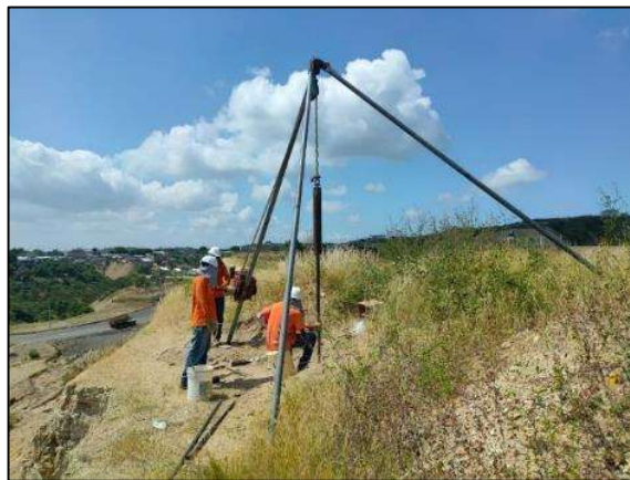
Figura 30. Ensayo SPT No. 1 en parte superior de talud
