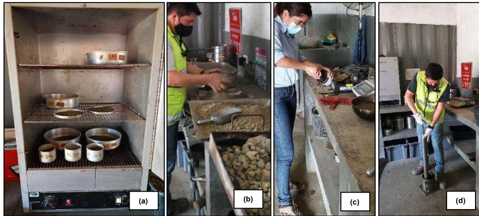
Figura 33. Ensayos normalizados realizados a las muestras de suelo en laboratorio: (a) Contenido de humedad, (b) granulometría, (c) límites de Atterberg, (d) proctor modificado.
