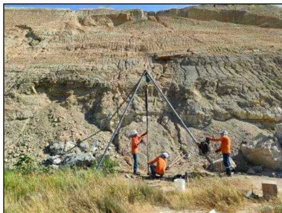
Figura 32. Ensayo SPT No. 3 en pie de talud
