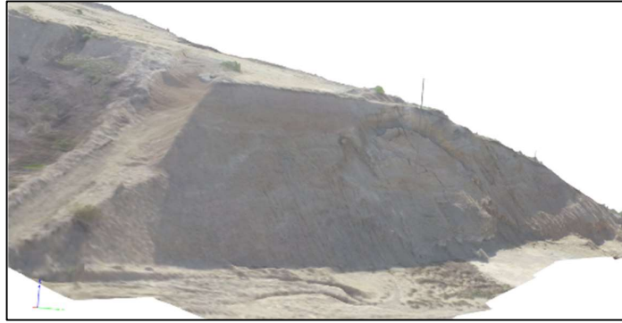
Figura 43. Vista en tres dimensiones del talud crítico, generado por el Modelo de Elevación Digital
