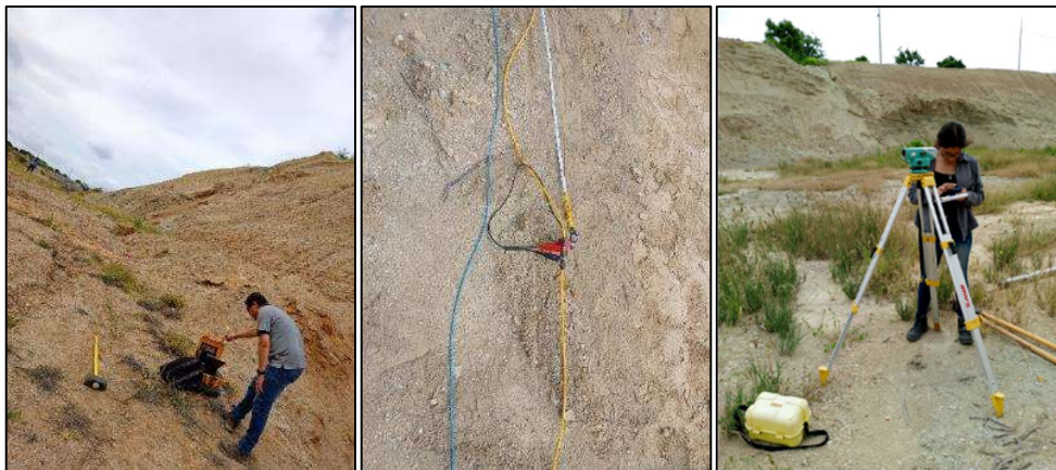
Figura 37. Configuración de líneas de refracción sísmica en el proyecto de estudio con su respectiva nivelación.
