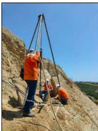
Figura 31. Ensayo SPT No. 2 en escarpe de talud
