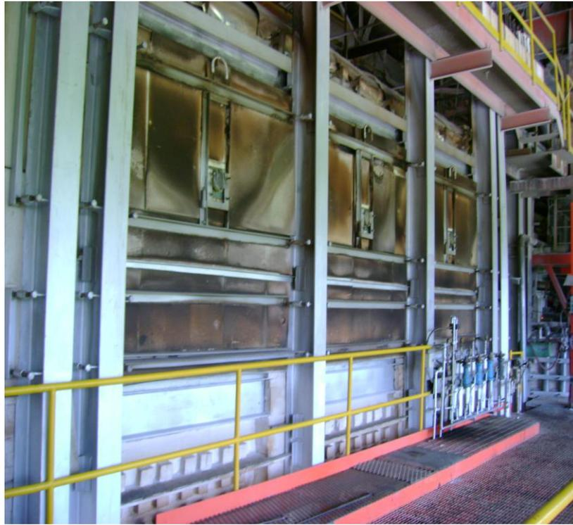
**FIGURA 2.8 HORNO DE MATERIALES REFRACTARIOS.**
