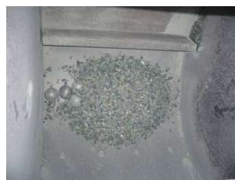
Foto 3.2.4.5.4 Interior de la Máquina de Los Ángeles
