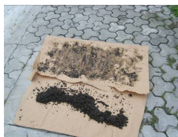
Foto 3.2.4.3.3 Secado de la arena sobre papel periódico
