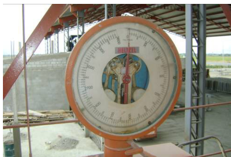
Foto 5.1.4 Dial de la dosificadora por peso
