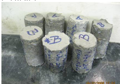
Foto 5.2.2.3 Cilindros calados de la tubería de 21" H.R.F.
