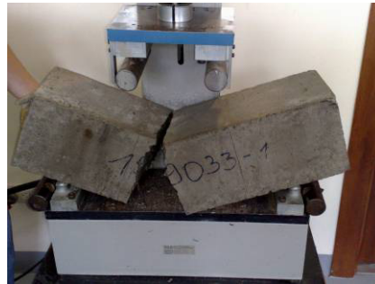
Foto 4.2.3.2 Viga ensayada a flexión
