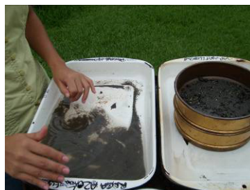
Foto 3.2.4.2.1 Lavado del material para separar partículas finas
