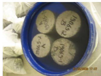
Foto 4.2.6.3 Núcleos sumergidos en el balde con agua
