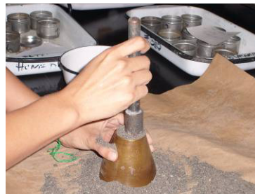
Foto 3.2.4.3.4 Apisonamiento de la arena en el cono metálico
