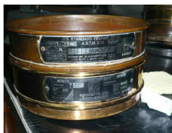
Foto 3.2.4.2.2 Tamices N°16 y N°200 para separar partículas grandes
