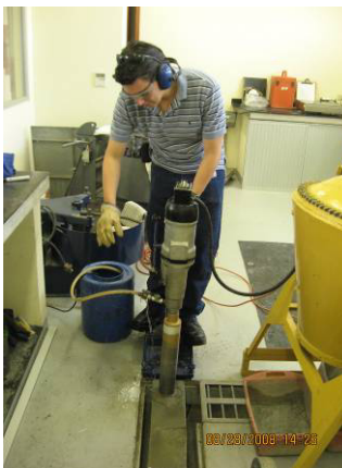
Foto 4.2.6.1 Extracción de núcleos en vigas ensayadas
