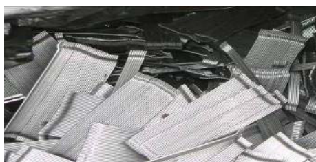
Foto 3.4.1 Fibras de acero Dramix RC-80/60-BN
