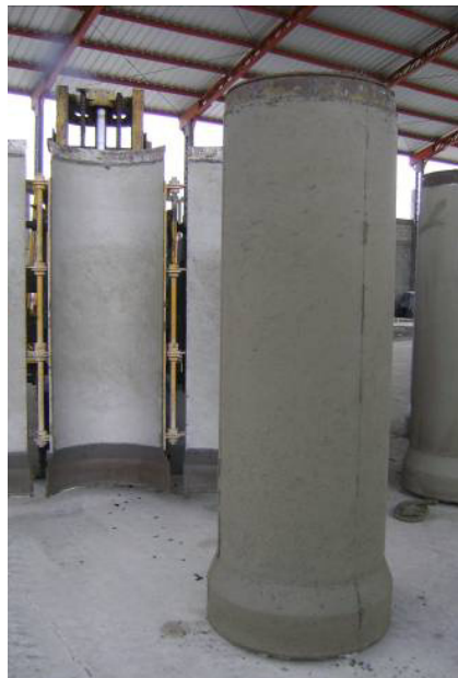
Foto 5.1.7 Tubería de 21” de H.R.F.
