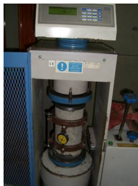
Foto 4.2.4.2 Cilindro con el deformímetro en la prensa o máquina de carga
