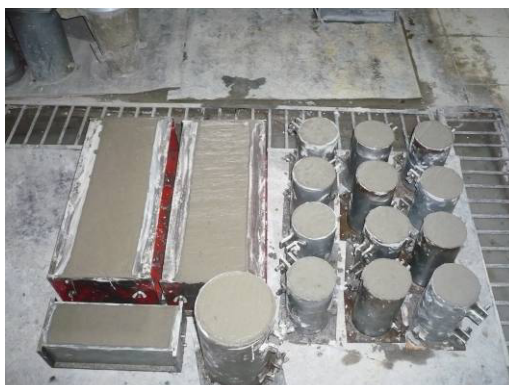
Foto 4.1.3 Especímenes elaborados para realizar ensayos al hormigón endurecido
