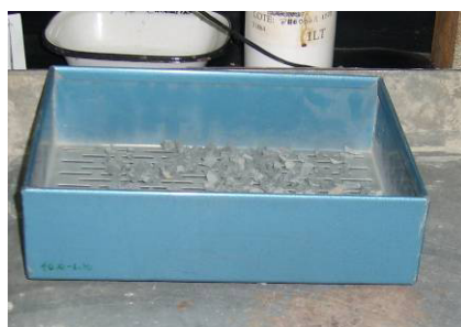
Foto 3.2.4.6.4 Partículas lajosas en su correspondiente calibrador
