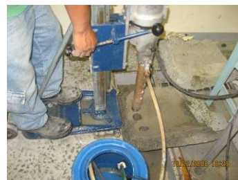
Foto 5.2.2.2 Extracción de núcleos
