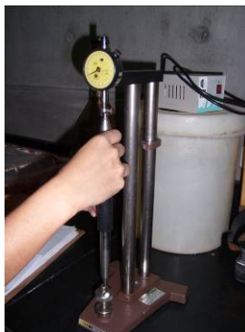
Foto 4.2.5.1 Deformímetro con dial y barra de calibración
