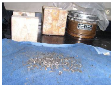
Foto 3.2.4.3.1 Secado de la piedra N°89 (estado SSS)
