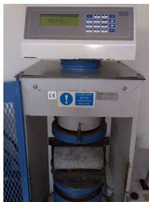
Foto 4.2.2.2 Cilindro a ser ensayado a Tracción por Compresión Diametral en la prensa de carga
