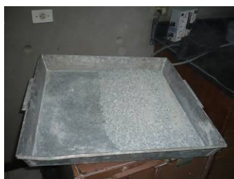
Foto 3.2.4.5.5 Material resultante después de las 500 vueltas
