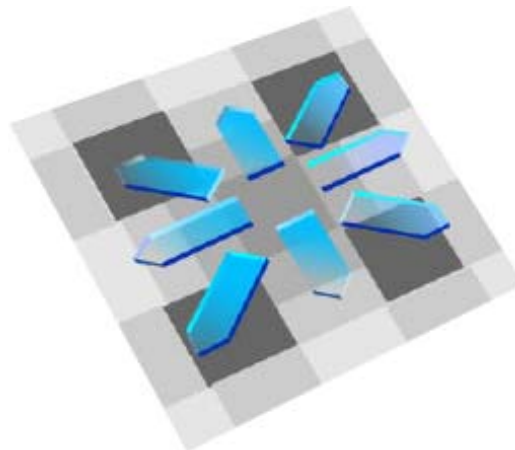
Figura 2.9 Interpolación Bicúbica. Crea un nuevo píxel basado en los vecinos horizontales , verticales y diagonales del área ya hecha padding.
