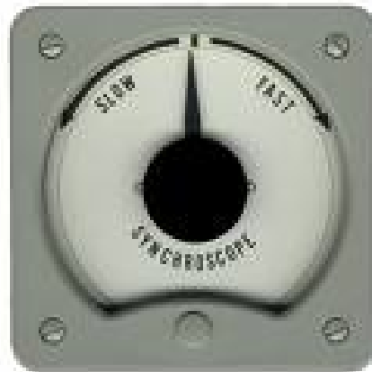
Fig. 3-11 Sincronoscopio en fase cero, es la posición de ángulo recto hacia arriba.
