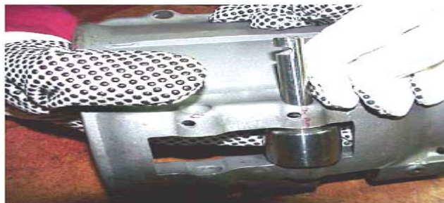
Figura 27 Ilustración sobre la forma de instalación de los ejes y rodillos en la camisa de acero fundido, cortesía de weatherford
