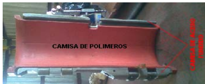
Figura 29 Postura correcta de la camisa de cojinetes dentro de la pieza fundida, cortesía de weatherford
