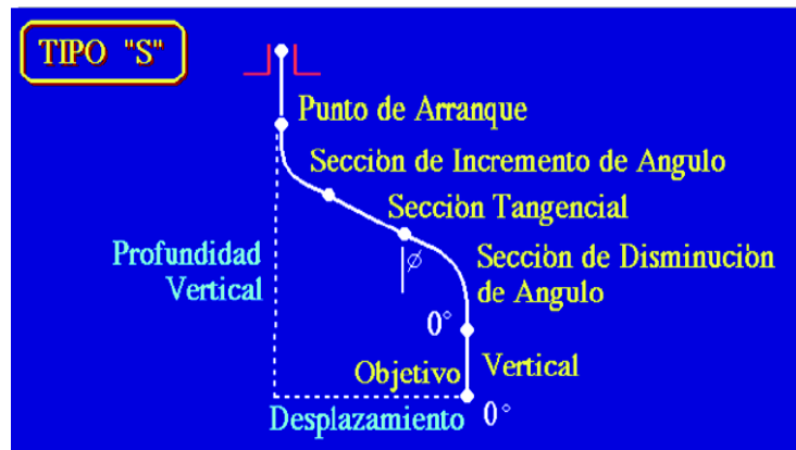
Figura 5 Tipo "S" su mayor complejidad es al tumbar ángulo construido, Sinopec internacional Petroleum
