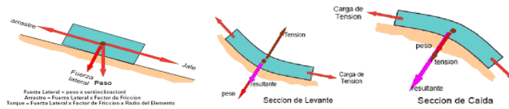
Figura 37 Componente de peso y tensión de la fuerza lateral, Schlumberger-aplicaciones torque y arrastre
