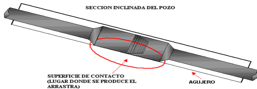
Figura 36 Tool Joint en contacto con una de las paredes del agujero en una sección inclinada, Manual de Weatherford
