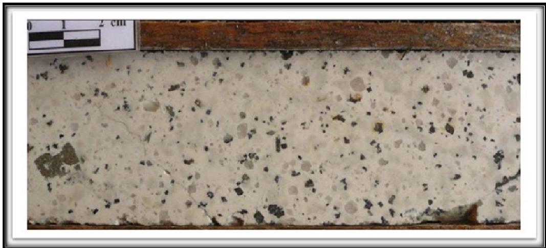
Foto 12. Diseminado de mineralización esfalerita – pirita alojado en un coherente pórfido cuarzo feldespático (riolita)
