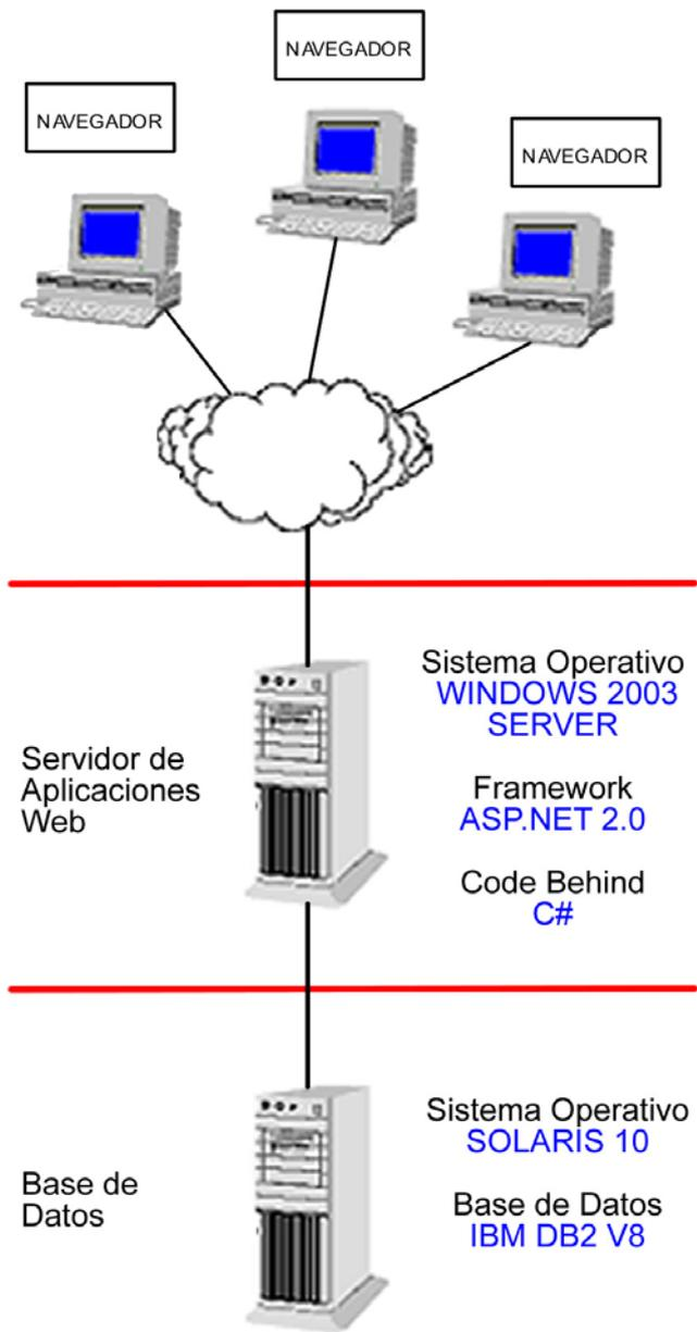
Figura 4.2 Software utilizado en las diferentes capas
