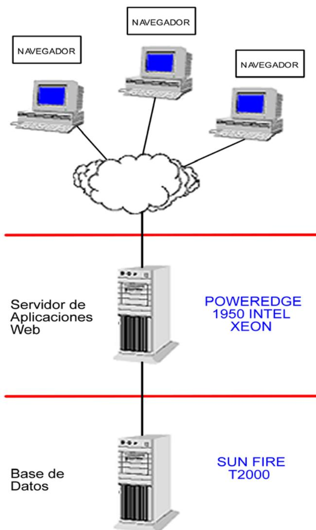
Figura 4.1 Hardware utilizado en las diferentes capas
