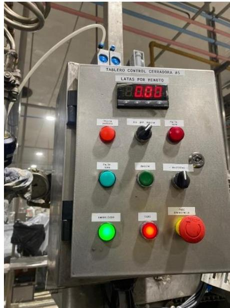
*Nota:* Vista general del nuevo sistema eléctrico instalado en la máquina cerradora de latas, optimizado para eficiencia y seguridad.
