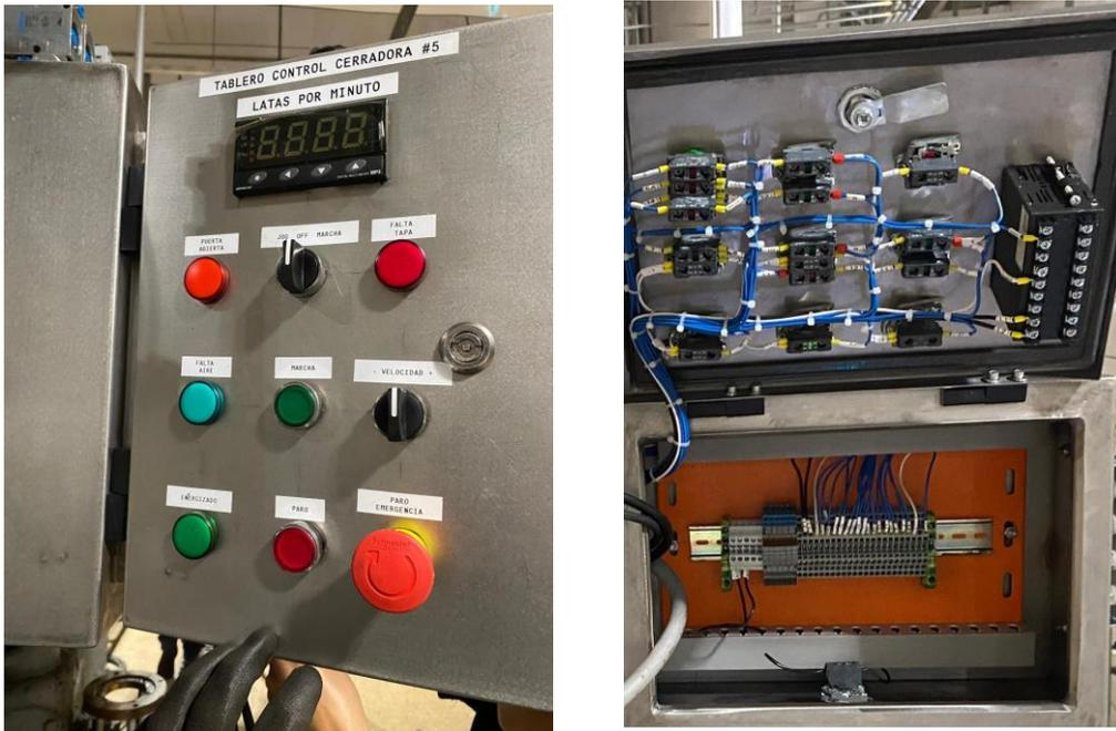
*Nota:* Disposición estratégica de los componentes eléctricos, con etiquetas claras, diseño ordenado y accesibilidad evidente para el personal de mantenimiento.
