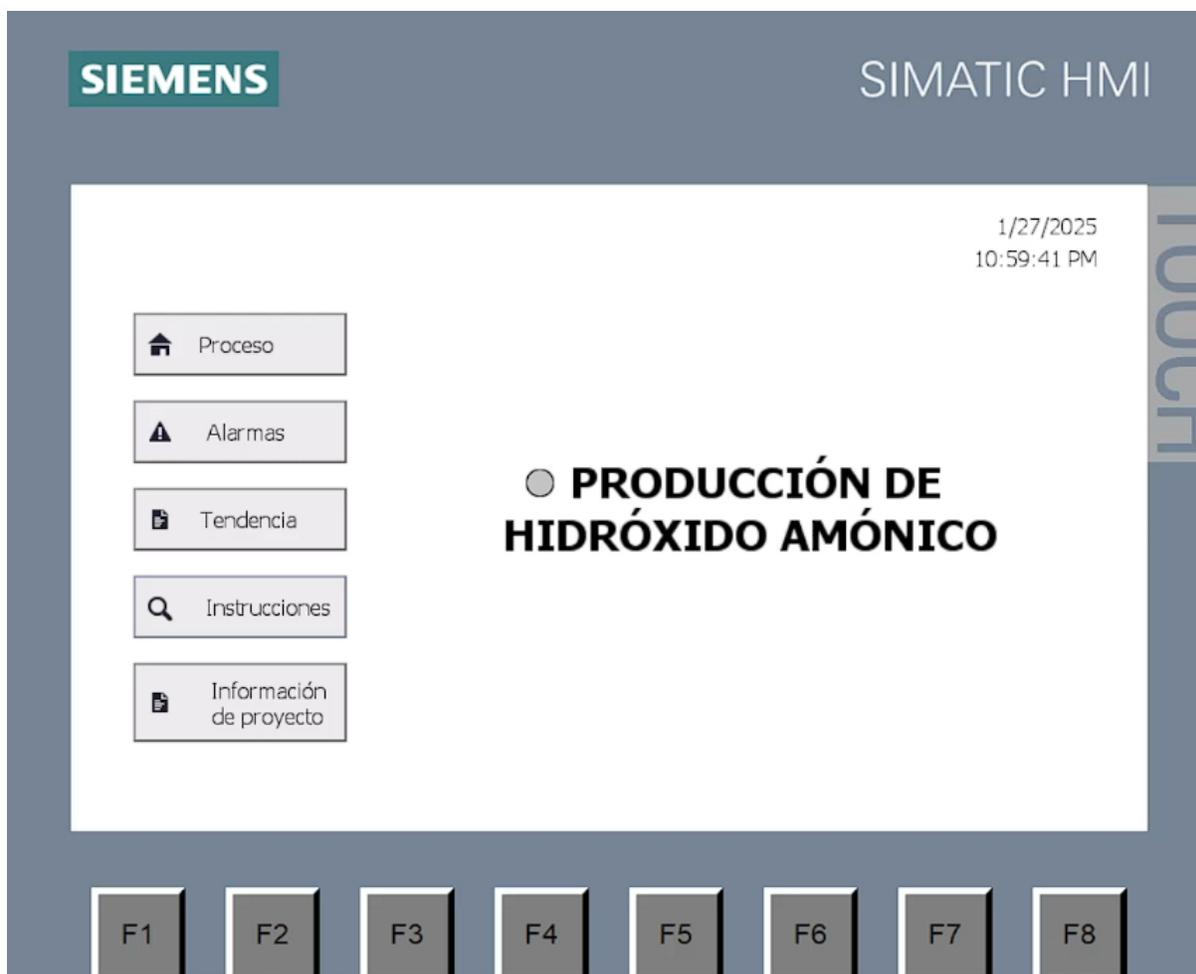
Debido a que el sistema cuenta con dos modos: automático y manual, se consideró incluir botones que dirijan al operador hacia pantallas respectivas dependiendo de la posición del selector físico colocado en el tablero de control. Las partes más importantes como el estado de las válvulas, valores de temperatura y presión, estado en tiempo real de la baliza e indicadores para los totalizadores de los flujómetros se encuentran presentes en esta pantalla, como se visualiza en la Figura 0.4.
