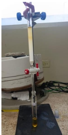
Elaboración de columna cromatográfica
