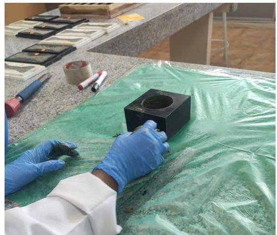
**Preparación de molde para ensayo de trabajabilidad**
