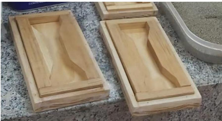
**Figura 2.12. Molde de madera en forma de lazo**
