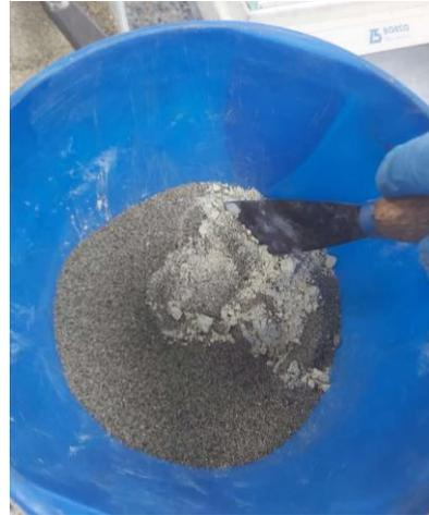
**Mezcla en seco de arena, caliza y zeolita**
