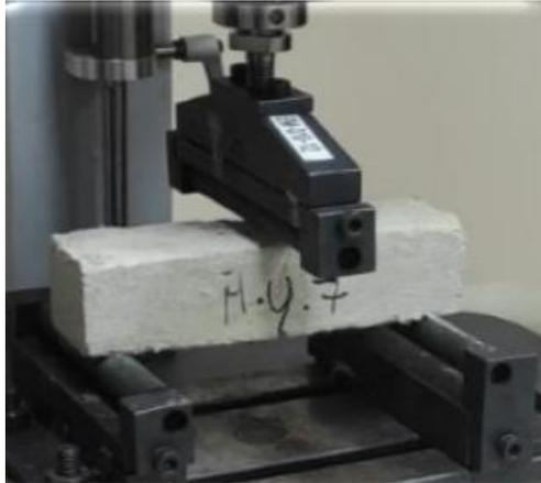
**Figura 3.5. Ensayo de Flexión de tres puntos (mezcla + fibra)**
