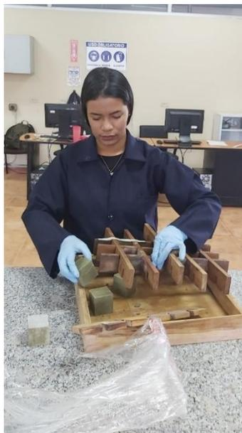
**Desmolde de probetas en forma de cubo, primera etapa**
