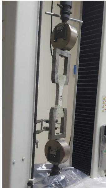
**Figura 3.6. Ensayo de Tensión (mezcla + fibra)**
