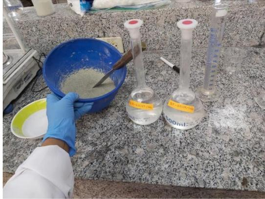
**Figura 1.6. Producción de geopolímeros (Material aluminosilicatos + solución alcalina = Geopolímero)**
