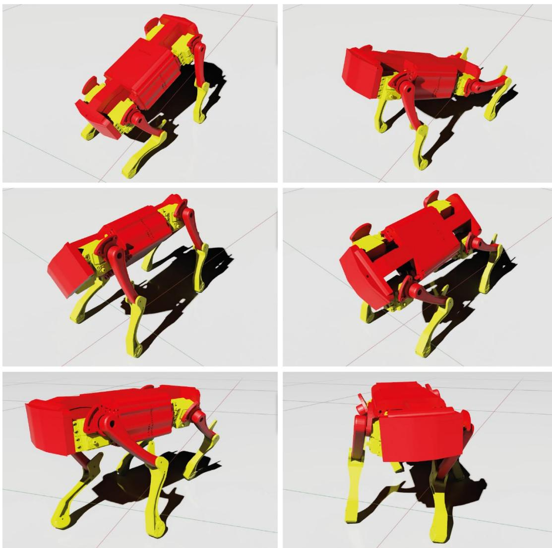
2. Caminata sencilla: El robot mueve una pierna a la vez, lo que le permite desplazarse hacia adelante, hacia atrás y rotar sobre su propio eje como puede apreciarse en la **Figura 3.18**.
