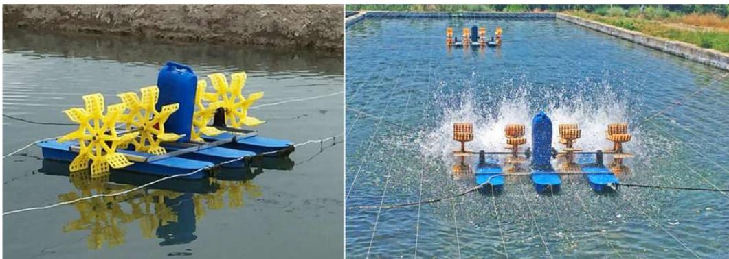
**Figura 1.3 Aireadores de tipo rueda de paletas flotantes al estilo asiático.**
