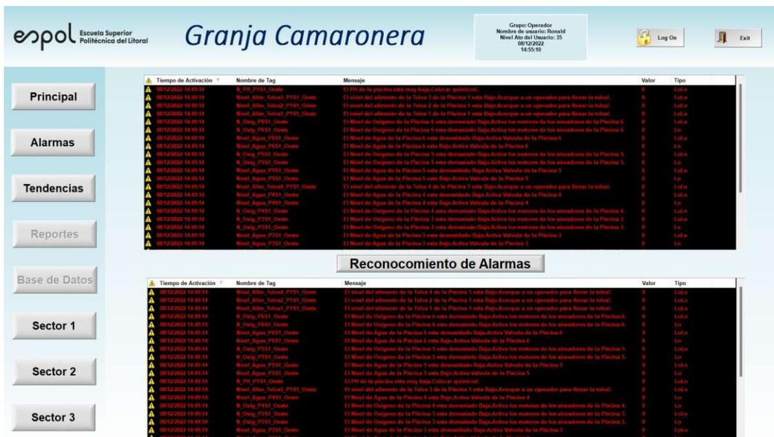
Figura 3.8 Pantalla de alarmas en un sistema SCADA.
