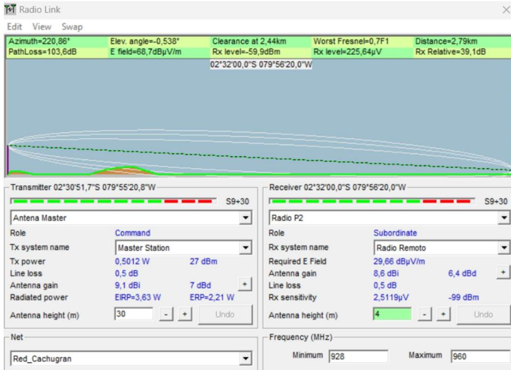
Figura 2.19 Punto remoto P2, 70% despejada, fuerza de señal -59,9 dBm (Señal idónea).
