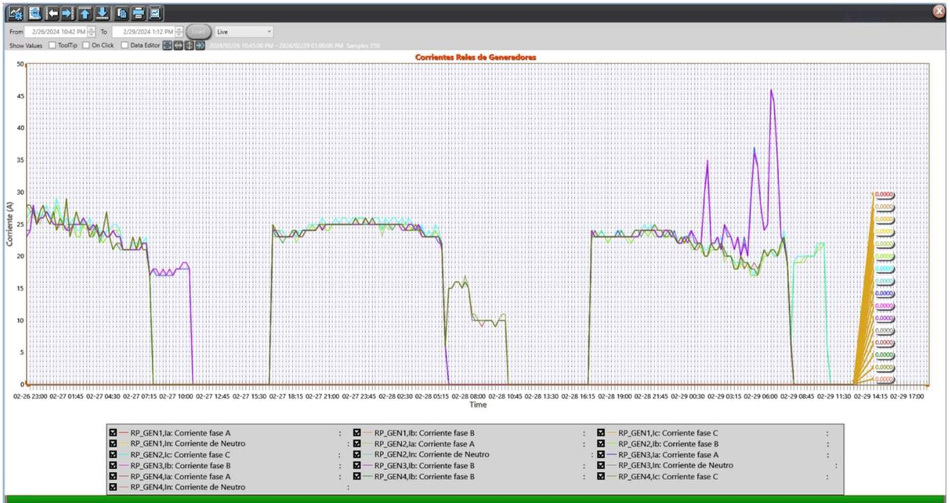
Figura 2.33 Curvas de Tendencia para análisis de consumo de energía.
