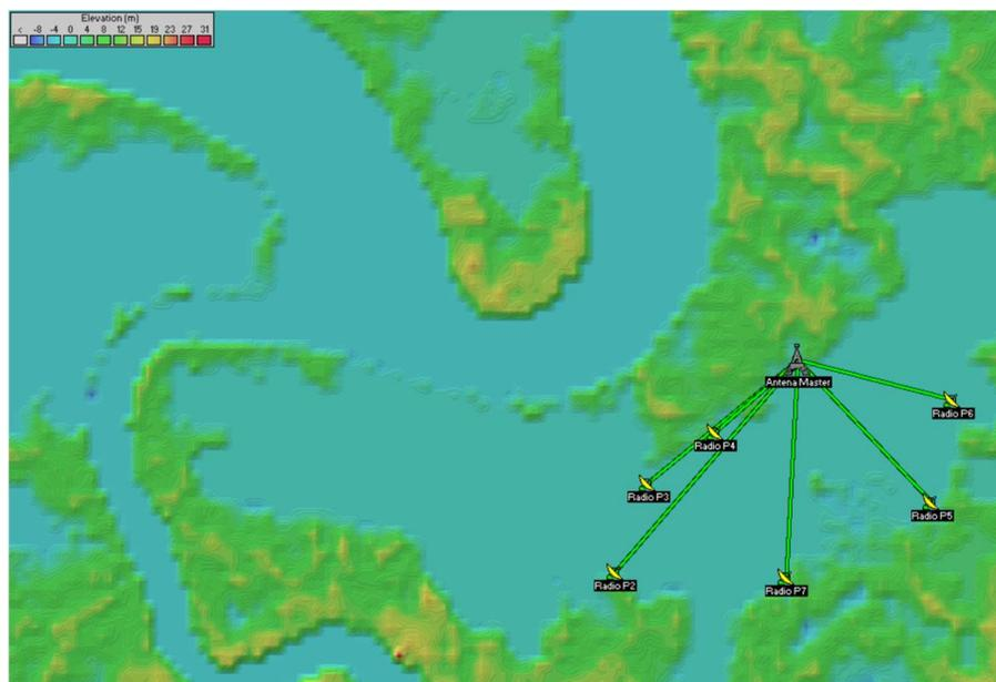
Figura 2.18 Mapa de obstáculos simulado en Software Radio Mobile.
