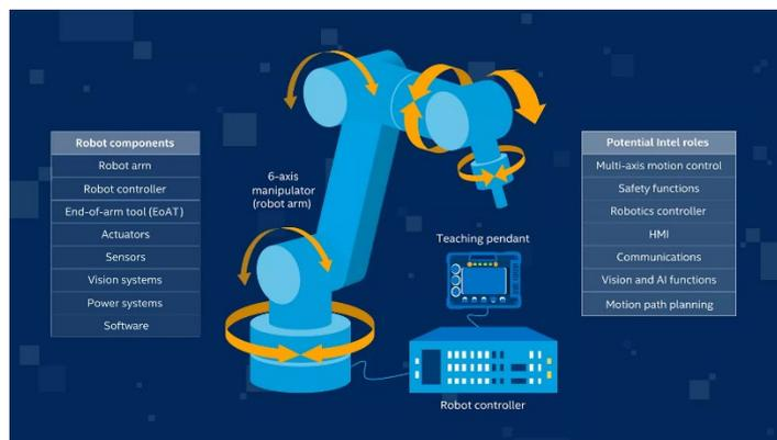
**Figura 1.4 Componentes de un brazo robótico industrial (Intel, 2020).**
