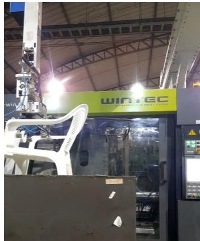
**Figura 1.1 Brazo de robot en maquina plastificadora.**
