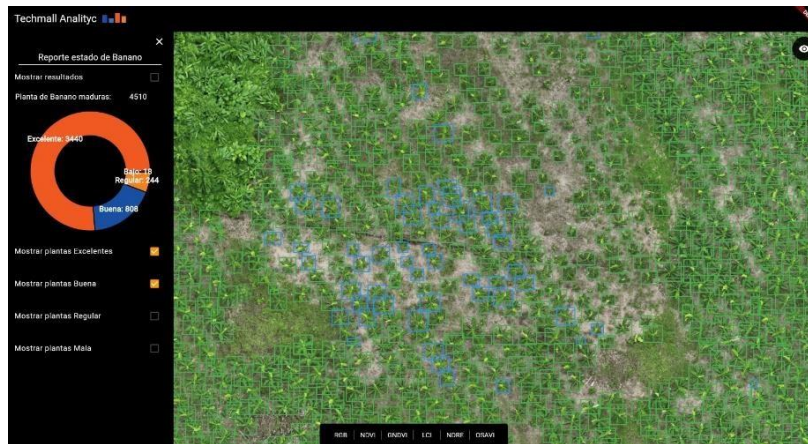
Figura 13. Página web mostrando los objetos captados por visión por computadora y clasificándolos por %NDVI
