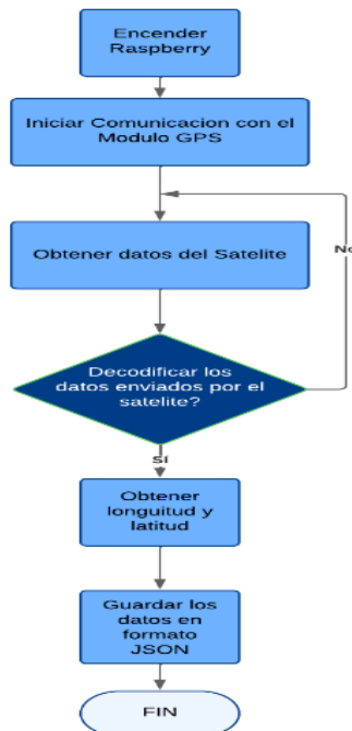
Figura 2. 3 Proceso del dispositivo GPS en el sistema. (Fuente: Autor)
