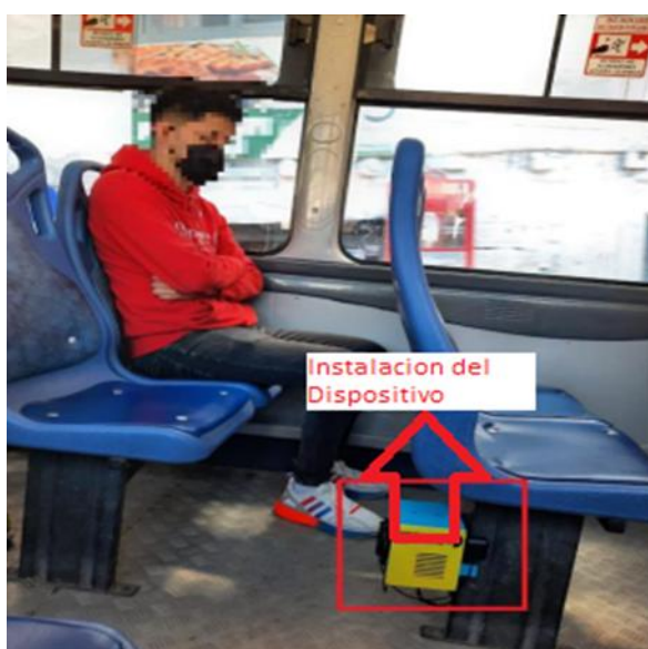
Figura 3. 1 Instalación de sistema de detección de Coordenadas. (Fuente: Autor)
