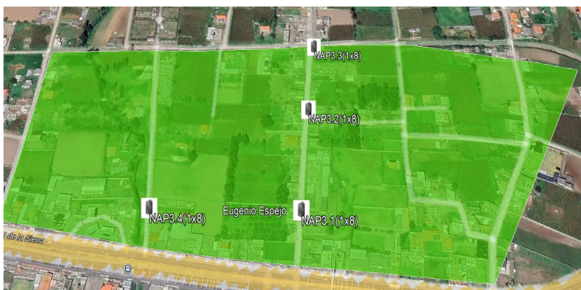
Figura 8. Distribución de cajas NAP en zona 3
