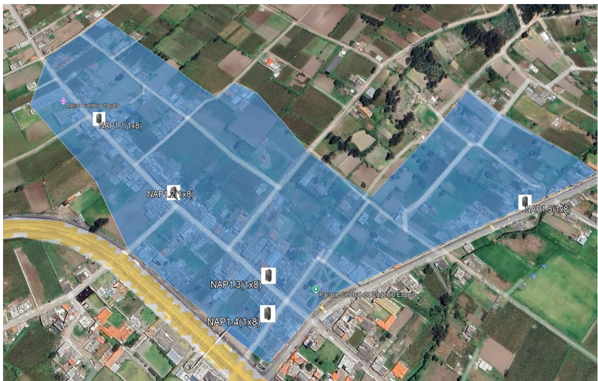
Figura 6. Distribución de cajas NAP en zona 1
