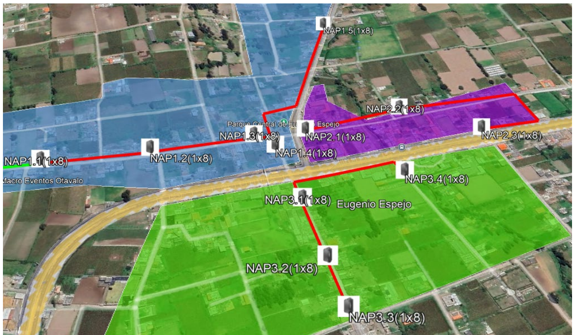
Figura 10. Derivaciones de fibra óptica
