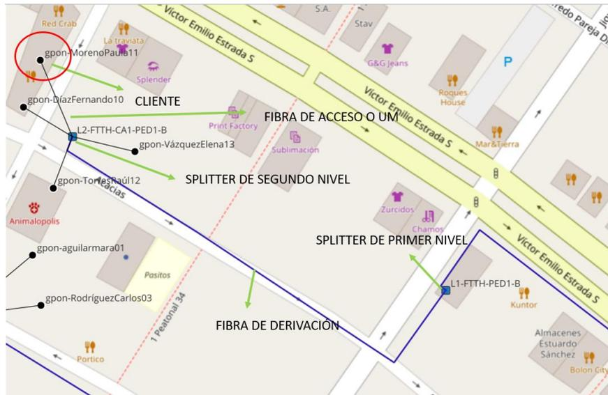
Figura 3.7 Red de fibra conectada a un cliente específico en QGIS.
