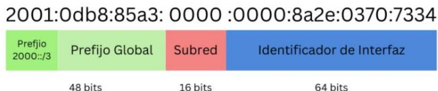
Figura 2.5 Direccionamiento IPv6 [19]
