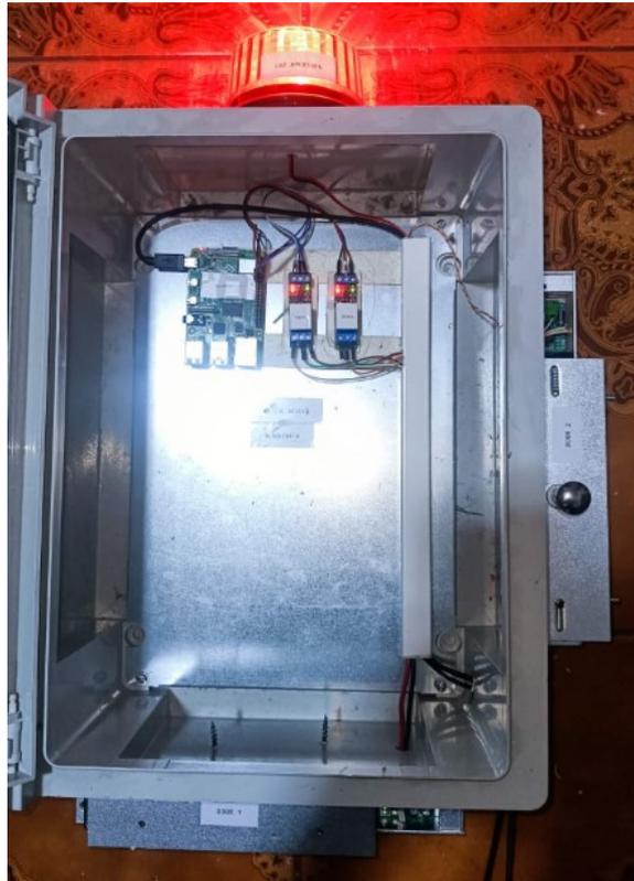
**Figura 3.16 Implementación de sistema de control de acceso**
