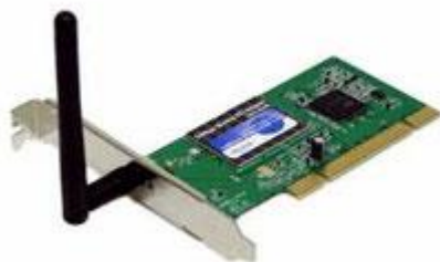
Ilustración 3 Tarjeta inalámbrica PCI (DAO APRENDIZAJE, s.f.)
