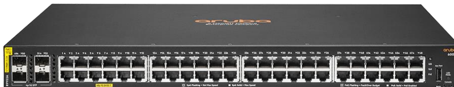
Ilustración 7 Switch Aruba 6000 48 G clase 4 PoE 4SFP 740 W (R9Y03A) (Hewlett Packard Enterprise Development LP, 2024)
