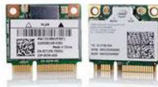
Ilustración 4 Tarjeta inalámbrica de portátil (DAO APRENDIZAJE, s.f.)
