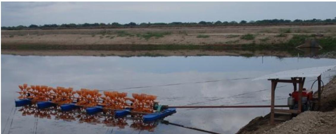
**Figura 4** Aireadores accionados por motores eléctricos
