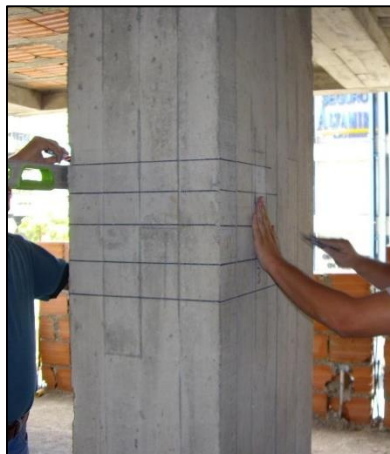
Figura 2.10 Preparación de la superficie para muestreo
