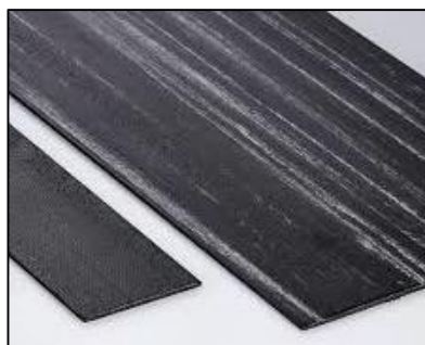
Figura 2.8 Barras de fibra de carbono. (Baquer, 2021)
