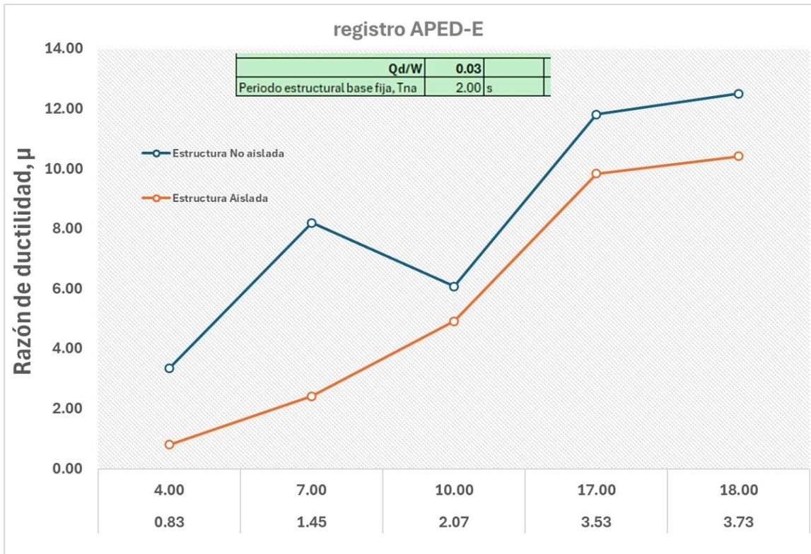
**Figura 6.9 Razón de ductilidad vs. Factores de Reducción de Resistencia**
