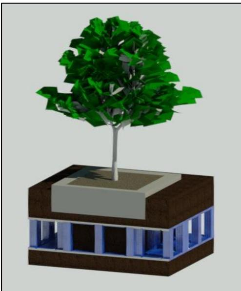
La forma en las que las celdas son constituidas le permite al árbol tener una mayor línea de crecimiento por parte de sus raíces. El espacio que se genera entre módulos está diseñado específicamente para que las raíces tomen su dirección en sentido de esos
