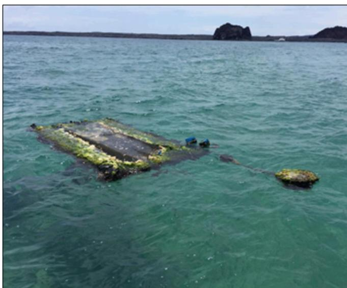
Figura 2. Estructura de DAP y ecosonda satelital amarrada, vista desde la superficie.
