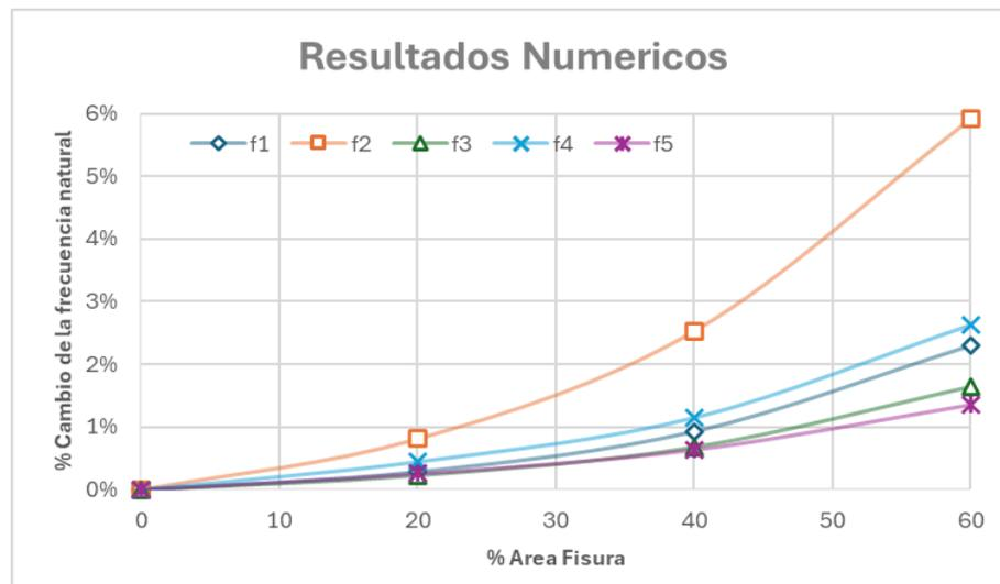
La influencia de las fisuras en los distintos modos de vibración se muestra en la Figura 29. El modo 2 (Figura 28-b) presenta la mayor variación en frecuencia natural, alcanzando hasta un 6% de diferencia cuando el área afectada por la fisura llega al 60%. Esto
