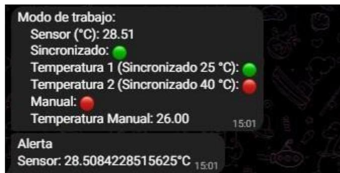
Figura 3. 14 Mensaje para visualización de modo de trabajo entre PLCs
