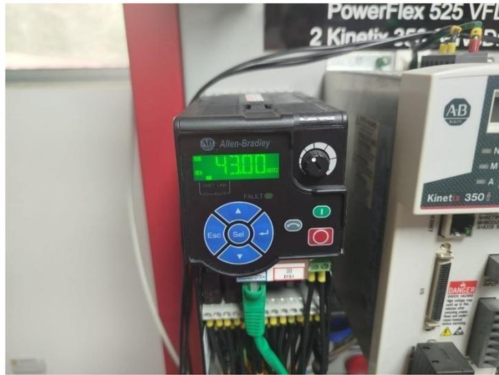
Figura 3.9 Display del PowerFlex 525 indicando la frecuencia actual
