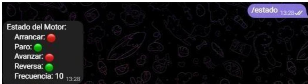
Figura 3.6 Comando definido para ver el estado del motor
