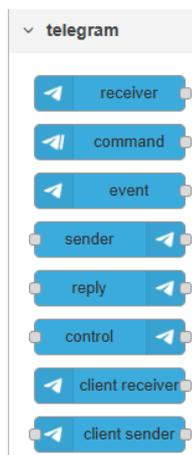
Figura 2.12 Nodos para comunicación con Node-Red y Telegram
