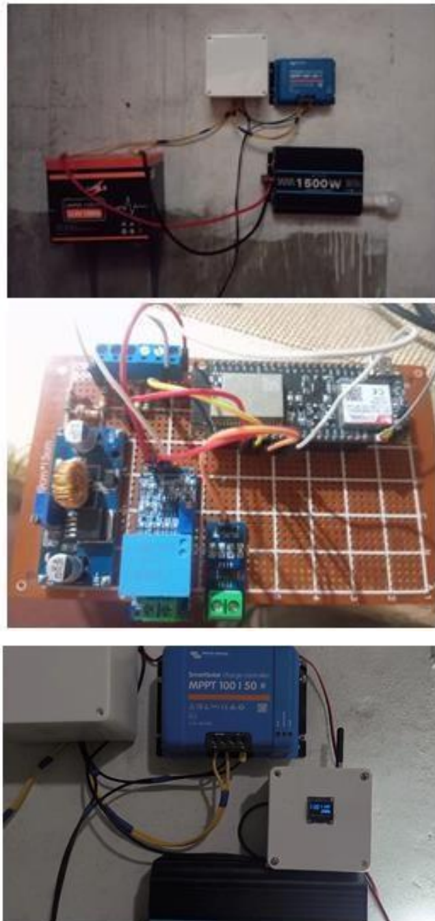
Figura 7. integración del ESP32 T-Call SIM800L, sensores y el sistema de transmisión de datos
