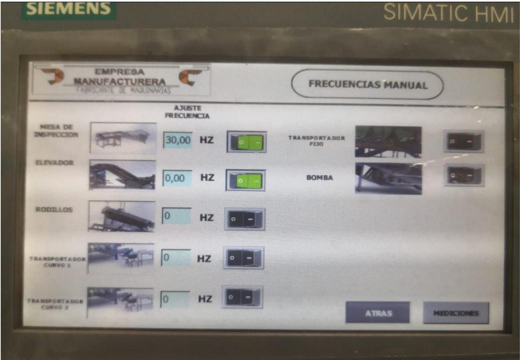
**Figura 3.12. Ajuste de frecuencia a 30 Hz de variador G120**
