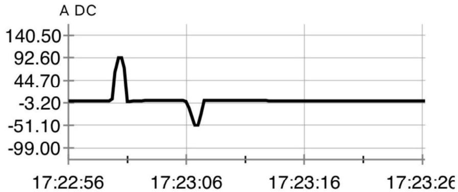
Actualmente, el vehículo está equipado con baterías de gel, pero al ser reemplazadas por baterías de litio, se obtendría el mismo comportamiento ilustrado en la figura 55. En este análisis, se utilizó el frenado electrónico, aprovechando la capacidad de frenado regenerativo del controlador. La gráfica muestra que, al acelerar el motor, la corriente fluye en un sentido indicando el consumo desde las baterías.
