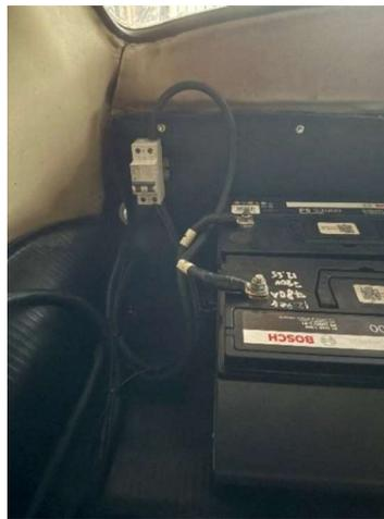
Toma tipo clavija para alimentación de baterías a 110 - 220 Vac
