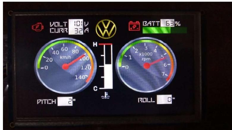
Se diseñó un dashboard que se puede visualizar en la figura 62, con ayuda de un HMI marca Nextion de 7 pulgadas, un tamaño adecuado para visualizar los parámetros más importantes del vehículo. Se realizaron simulaciones para visualizar el comportamiento del dashboard, estas fueron las primeras pruebas a realizar, el sistema permite supervisar las siguientes variables:
