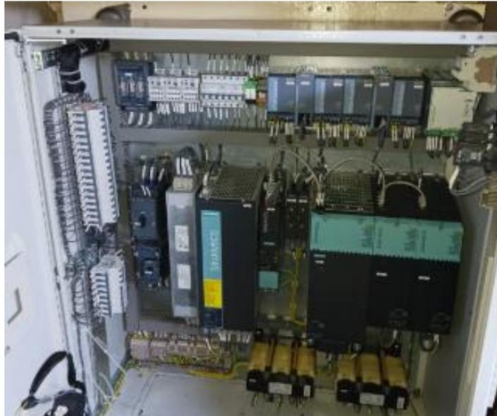
*Ilustración 7 Servosistema s120 implementado*
