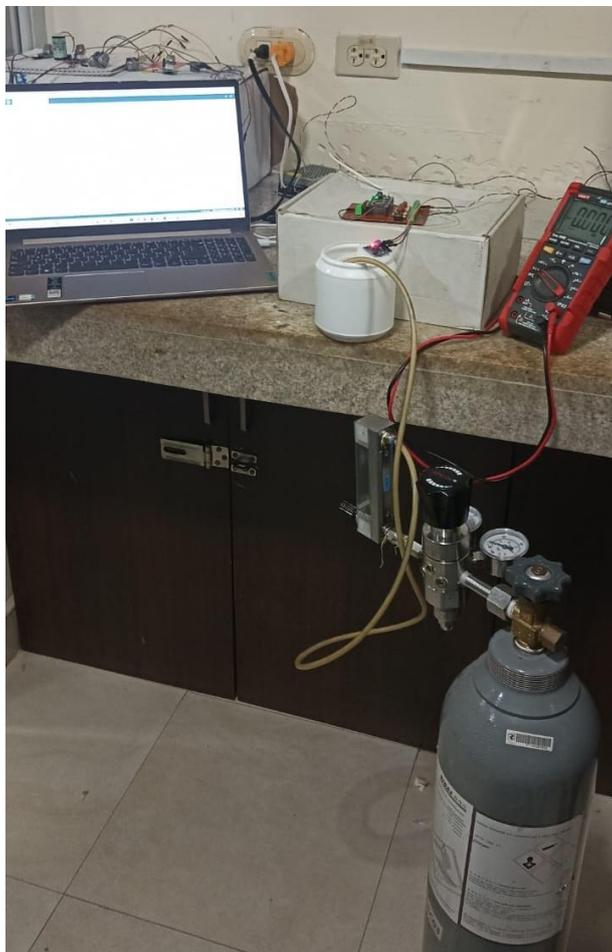
Para efectos de calibración se utilizó el método de comparación directa con materiales de referencia, en nuestro caso, con gases patrón para calibración.
