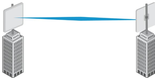
*Ilustración 9 Conexión punto a punto[14]*
