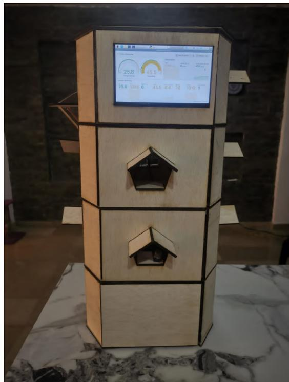
Figura 4.8: Sistema de monitoreo en prototipo de madera
