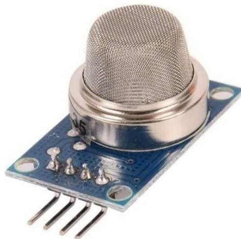
Figura 2.2: Sensor MQ135, módulo encargado de capturar y transmitir datos de CO Y CO<sub>2</sub> hacia el microcontrolador. Imagen tomada de (Jabots, 2024)
