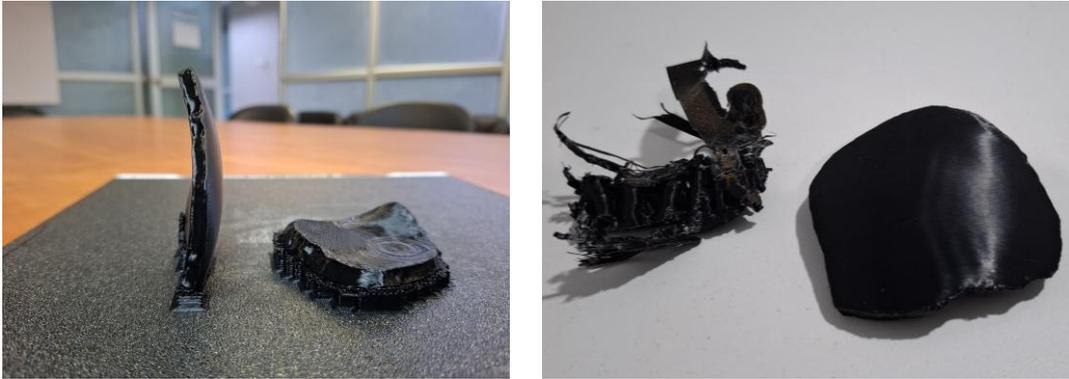
**Figura 3.14 Postprocesos; (A) Biomodelos impresos en dos orientaciones distintas (B) Soportes removidos de biomodelo**
