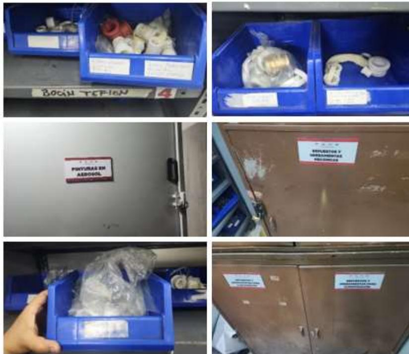
**Figura 2.9 Repuestos clasificados según máquina en gavetas**
