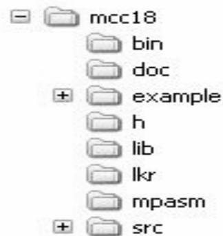
Figura 3.6 Estructura de directorio de instalación de MPLAB IDE
