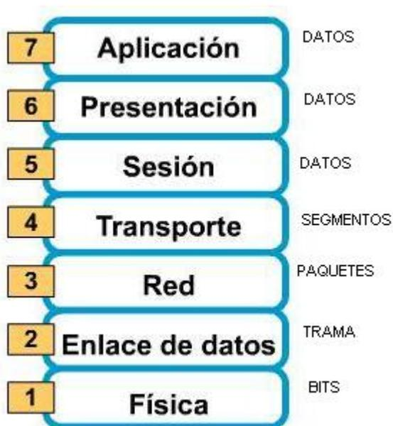
Figura 2.1 Representación gráfica de las capas del modelo OSI
