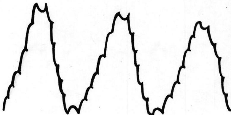
FIG 2.1.9. CORRIENTE DEL MOTOR CON UN PAM DE DOCE PULSOS (CARGA Y VEL 100%)
