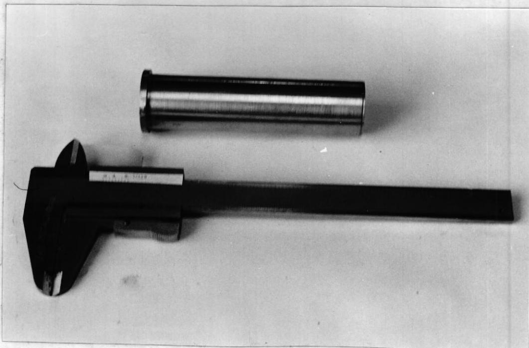
La probeta utilizada en el Ensayo Jominy es de 0/ 1" - y 4" de longitud con una pequeña ceja en uno de sus extremos para poder ser colocada en el dispositivo de temple, y ha sido mecanizada a partir de una barra de acero Andec extraduro de 32 mm.
