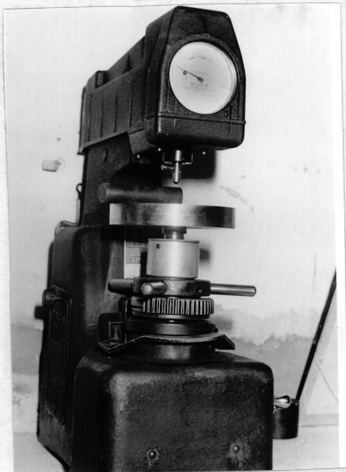
Se utilizó el aparato de medir durezas Rockwell que hay en el Laboratorio de - Metalurgia de la ES-POL.
