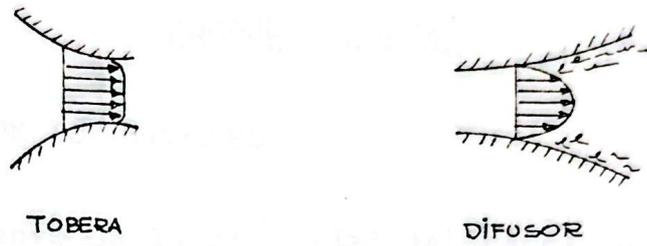
FIG. 3.11.- Disposición de la capa límite en toberas y difusores.
