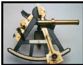
Figura 1-12 Octante con Tornillo de Ajuste. <sup>xii</sup>
