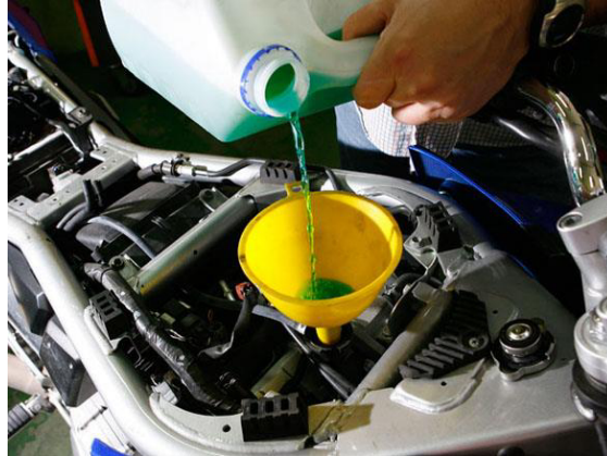
FIGURA 3.3 USO DEL REFRIGERANTE EN EL MOTOR
