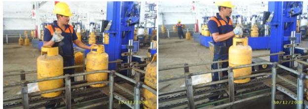
**FIGURA 2.10 COLOCACIÓN DE SELLO DE SEGURIDAD**
