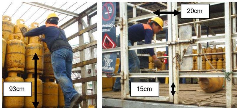
**FIGURA 2.21 TERCER ELEMENTO – APILAMIENTO DE CILINDRO LLENO**
