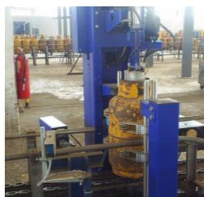
**FIGURA 2.9 VERIFICACIÓN DE FUGA**
