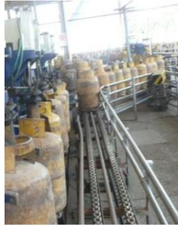
**FIGURA 3.10 TRANSPORTADOR DE CILINDROS**
