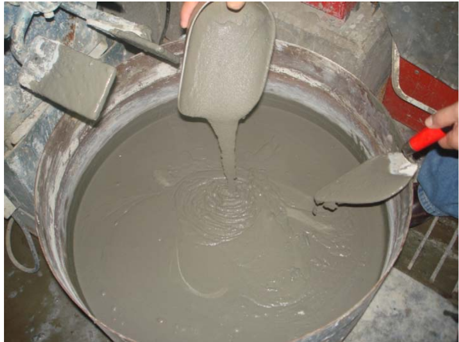
FIGURA 4.1 Mezcla de los componentes del HPR
