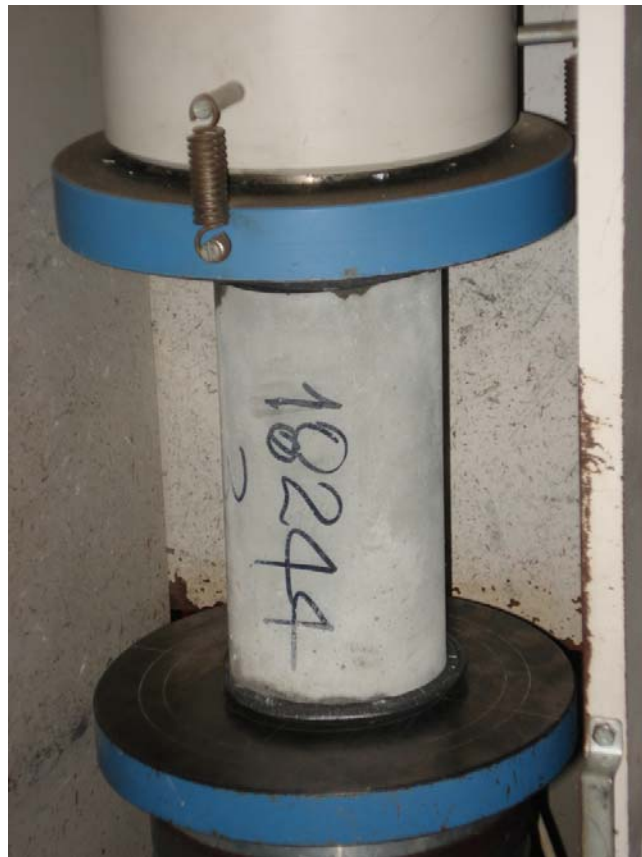
FIGURA 4.2. Ensayo de compresión simple
