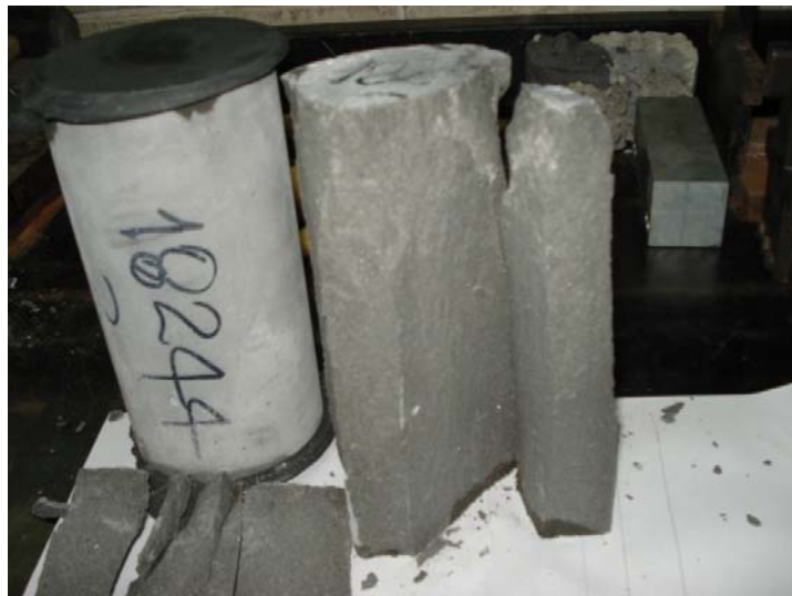
FIGURA 5.1. Rotura de cilindros por compresión simple
