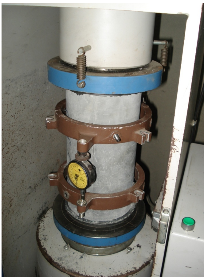
FIGURA 4.6. Ensayo para determinación de módulo elástico.
