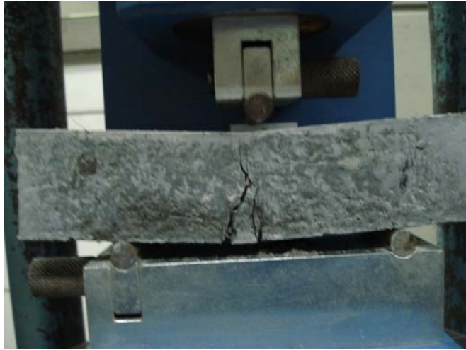
FIGURA 5.8. Rotura a flexión de viga de 16x4x4 cm
