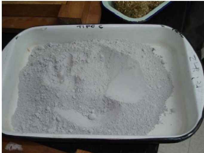
FIGURA 3.4. Polvo reactivo proveniente de la trituración de arena de cuarzo
