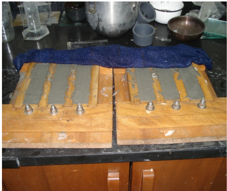
FIGURA 4.7. Barras de HPR que serán ensayadas a resistencia a sulfatos y reacción álcali – sílice
