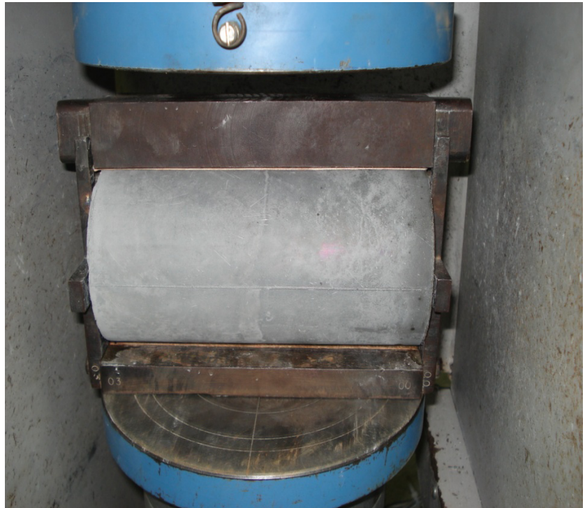
FIGURA 4.4. Ensayo del HPR de tracción por compresión diametral.
