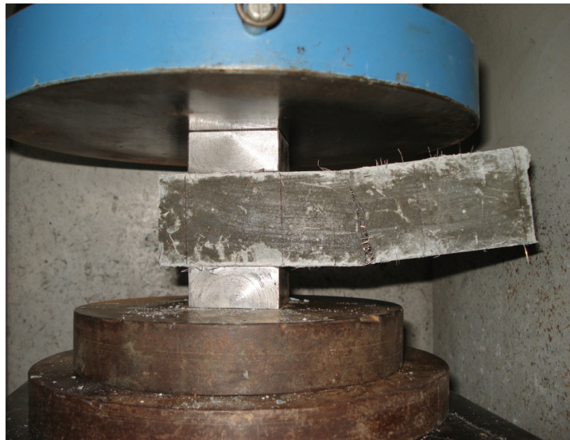
FIGURA 4.3. Ensayo de compresión de fragmentos de vigas a manera de cubos
