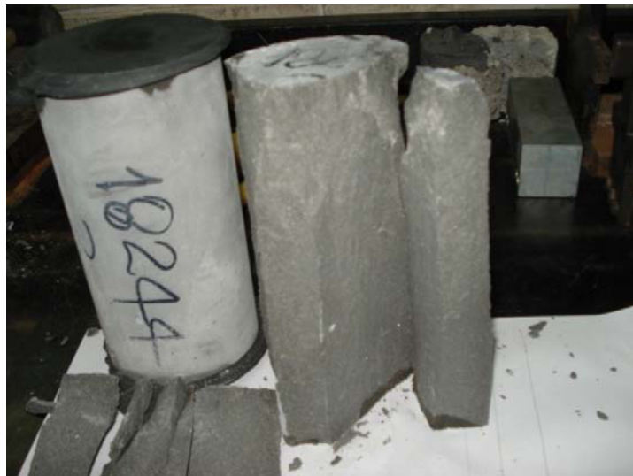
FIGURA 5.1. Rotura de cilindros por compresión simple
