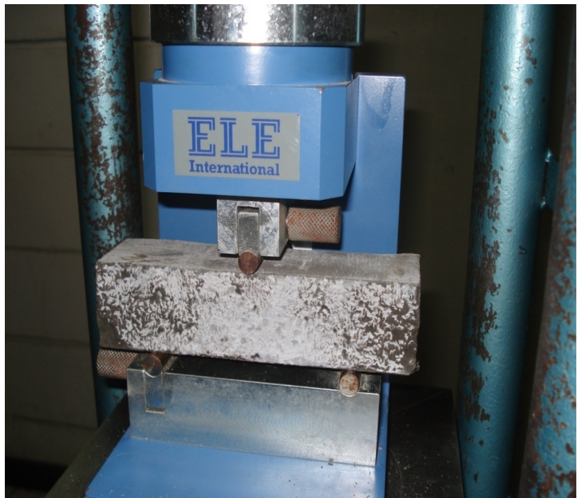
FIGURA 4.5. Ensayo a flexión de vigas pequeñas de HPR.
