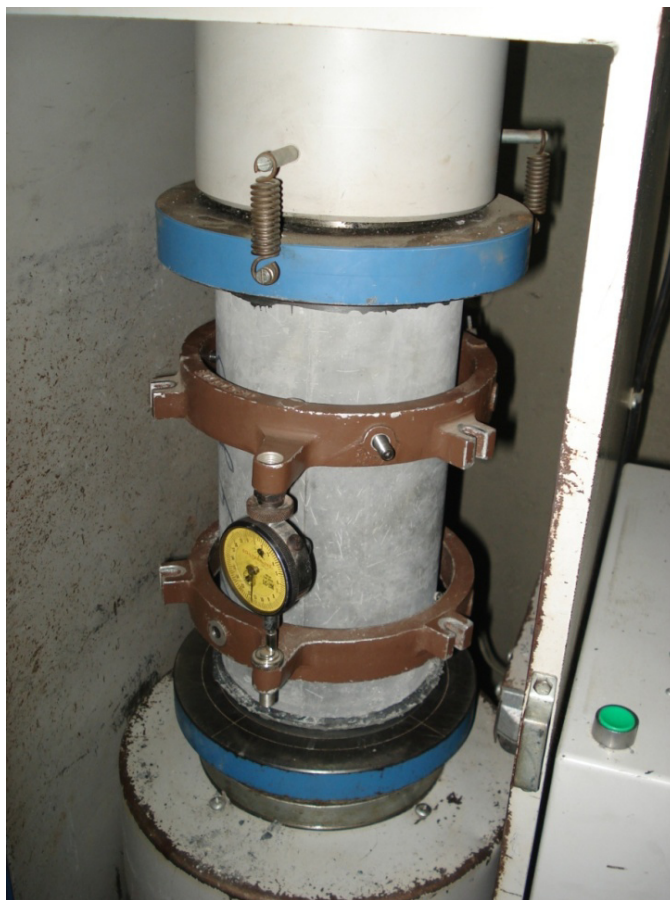
FIGURA 4.6. Ensayo para determinación de módulo elástico.
